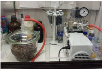
Abb. 2: Inokulation der Esca-Erreger in einem Glasbehälter mit Sporensuspension. Die Besiedlung der Stecklinge mit den Pathogenen erfolgte durch Überdruck für 15 Minuten.
